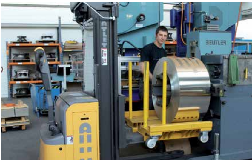
Ruck-Zuck klappt das Handling mit dem prämierten „Coilwagen“ – ergonomisch sinnvoll, Material schonend und deutlich wirtschaftlicher.
